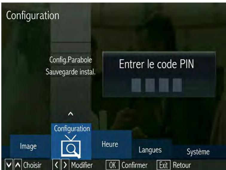
Ces sous-menus RESERVES au professionnels permettent de configurer l'installation parabolique et en sauvegarder les données.
